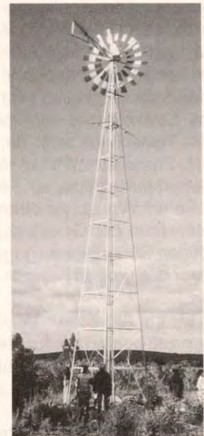
Das 15 m hohe Windrad pumpt das Wasser zur Bewässerung.
